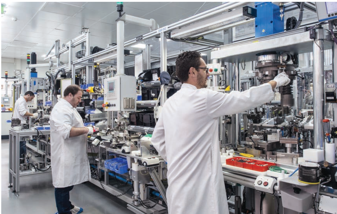
Vorerst ist Lean Management nur auf den Produktionssektor beschränkt, später soll es auf das gesamte Unternehmen Liebherr Maschinen Bulle ausgeweitet werden – hier die Montagelinie der Diesel-Einspritzsysteme im Reinraum.
