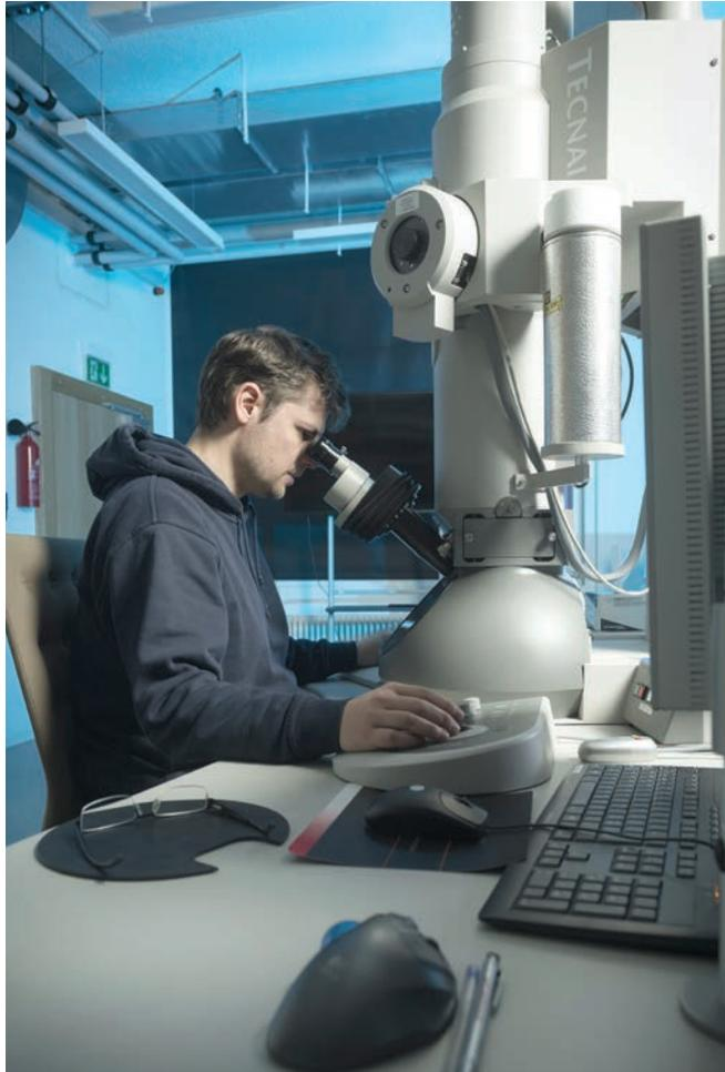
L'Institut Adolphe Merkle est à la pointe de la recherche internationale dans le domaine des nanosciences et des sciences des matériaux – ici une observation via un microscope électronique en transmission.
