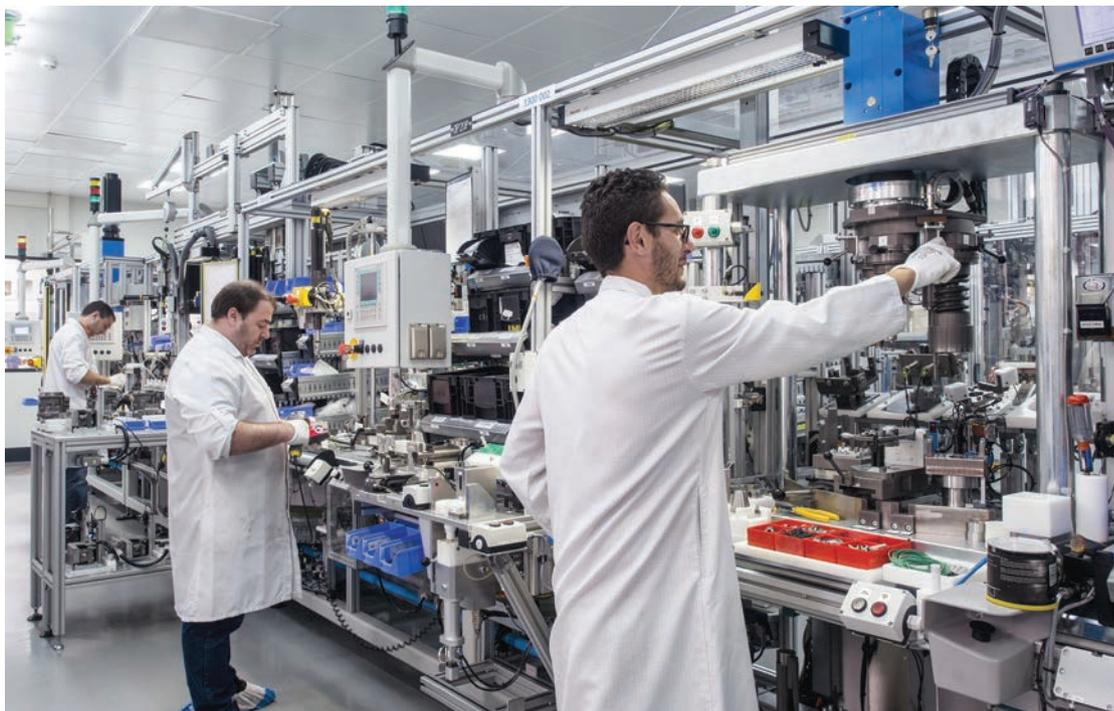
Avant de s'étendre à l'ensemble de Liebherr Machines Bulle, le *Lean Management* s'est d'abord appliqué à l'unité de production – ici la ligne de montage des systèmes d'injection Diesel, en salle blanche.
