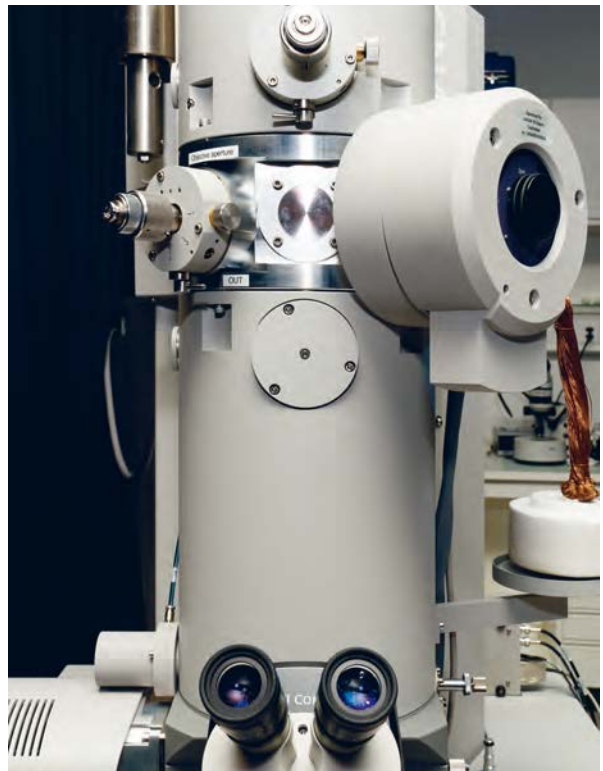
AMI透射电子显微镜（TEM）通过高压电子束来检测纳米粒子。
