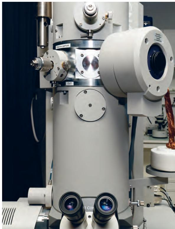
Das Transmissionelektronenmikroskop (TEM für Transmission Electron Microscope) des AMI verwendet einen Hochspannungselektronenstrahl, um die Nanopartikel zu visualisieren.
