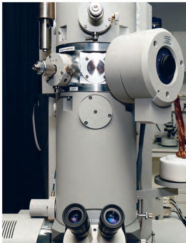
Le microscope électronique en transmission (ou TEM pour Transmission Electron Microscope) de l'AMI utilise un faisceau d'électrons à haute tension pour visualiser les nanoparticules.
